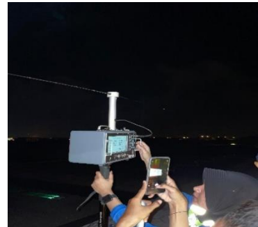
Gambar 33. Pengecekan pancaran menggunakan PIR
