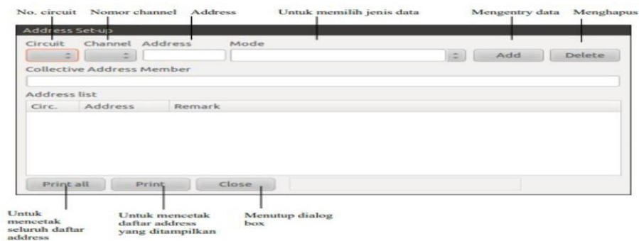
Gambar 19 Adress Setup Pada Supervisiom AMSC
