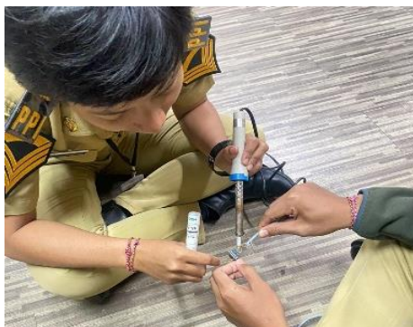
Gambar 15 Menyolder Pin 5 Kabel DB-9 Sumber: Dokumentasi Penulis, 2023
