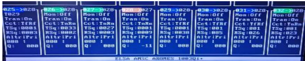
Gambar 20 Channel 28 Alarm Pada Monitor AMSC
