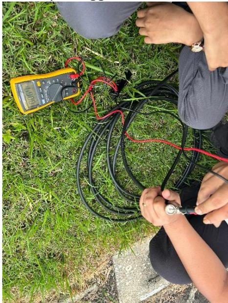
4. Setelah dilakukan pengecekan *continuity*, ditemukan ujung konektor kabel menuju antena mengalami korosi dikarenakan pembungkus konektor terbuat dari *rubber* yang posisinya sudah mengelupas termakan oleh waktu.
