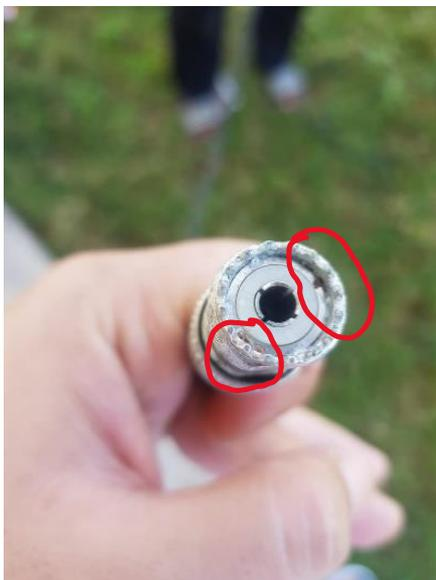
5. Kemudian konektor kabel dibersihkan menggunakan *contact cleaner* namun, setelah dicek nilai VSWR pada *monitor display* VHF APP frekuensi 124.0 MHz masih tinggi yaitu 3,5.
